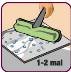
Vorbehandlung allseitig auf Platte auftragen
